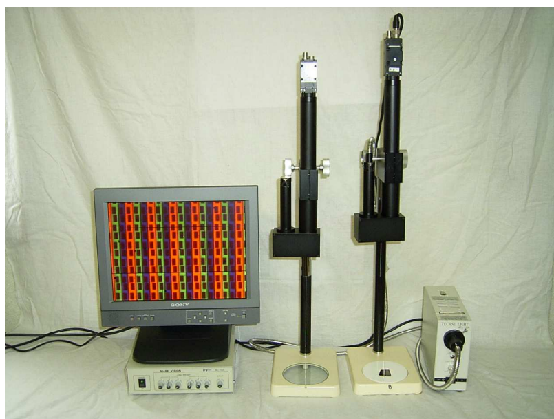
印刷機ステージに2台設置して、電子ラインとトンボマークをアライメント
